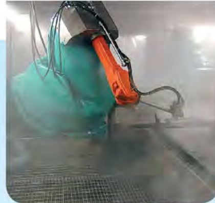
Роботизована очистка на автомобільному заводі 900 bar.
