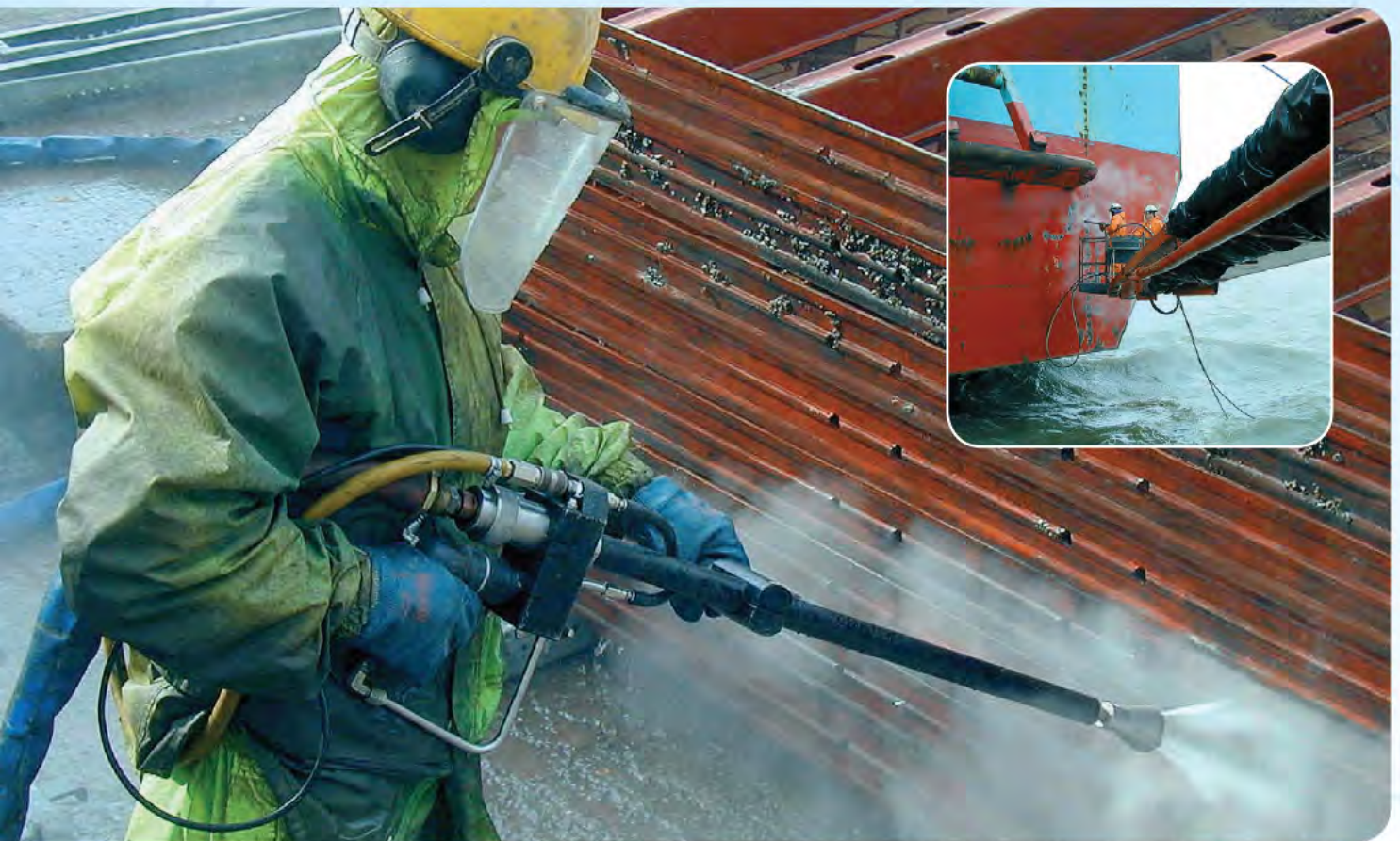
Головне зображення: Видалення бетону з форм при 2500 bar Вставка: Очистка поверхні, корабель при 2800 bar
